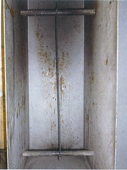
fig 1.: test rig IEC 60332-1-2
