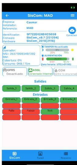
**Imagen 28.** Pantalla Siscom o de estado. Muestra el estado general del transmisor, de igual forma que la pantalla de estado del software PC.
