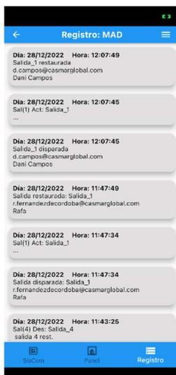
**Imagen 29.** Pantalla de Registro de Eventos. Muestra el registro de eventos del transmisor, de igual forma que la pantalla de registro de eventos del software PC.
