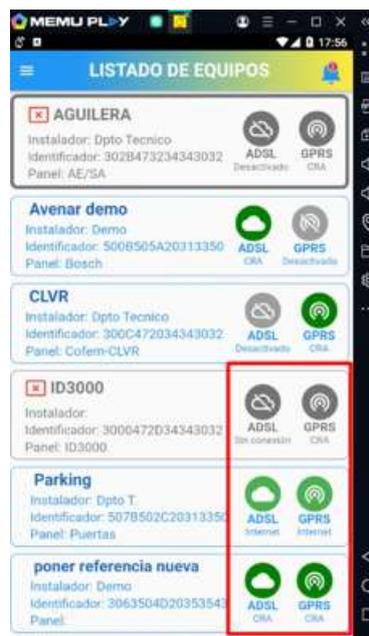
**Imagen 23.** Pantalla de Inicio de la APP. Listado de instalaciones del usuario, con datos de aquellas que están conectadas, en función de la vía de conexión utilizada (en verde, se marca si hay conexión).
