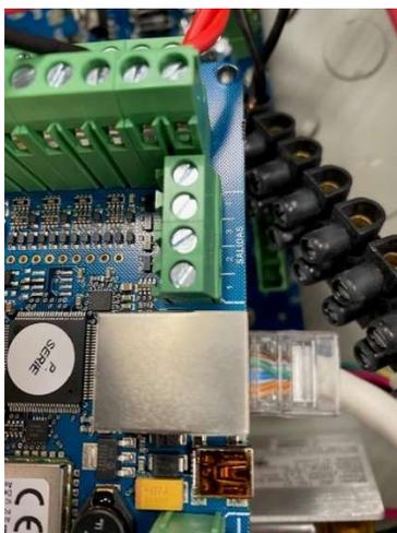
**Imagen 31.** Salidas del transmisor SISCOP-F y RJ-45. Negativo en bornes tras la activación.
