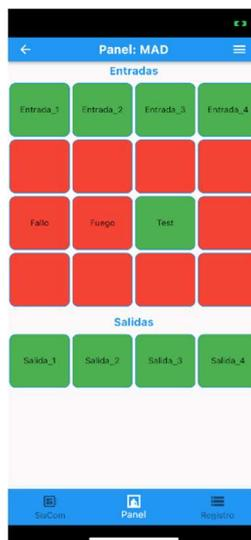
**Imagen 27.** Pantalla de Panel. Desde esta pantalla se muestra el estado de todas las entradas y salidas del transmisor. También se puede desde esta pantalla, actuar sobre las salidas del transmisor, activándolas remotamente.
