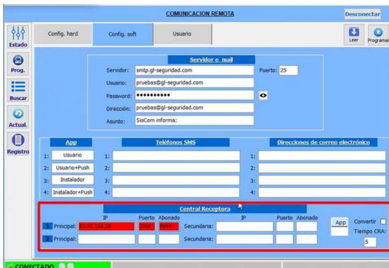
**Imagen 14.** Pantalla de configuración del software. En este apartado se pueden modificar los datos de conexión a receptora, así como el tiempo de conexión a esta (5 minutos por defecto). Para el correcto funcionamiento entre el SISCO-F y la Central Receptora de Alarmas, ésta debe tener instalado el programa SisCom Receptora.
